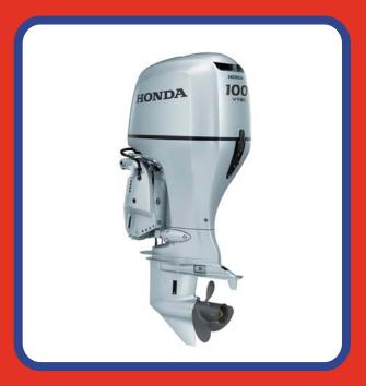
Meilleur compromis entre performances et sobriété, le BF100 est équipé des dernières technologies Honda. Vous profitez des performances exceptionnelles d'un moteur VTEC et d'un maximum de puissance à bas régime grâce au BLAST. Moteur dérivé de l'automobile, sa fiabilité n'est plus à prouver.
